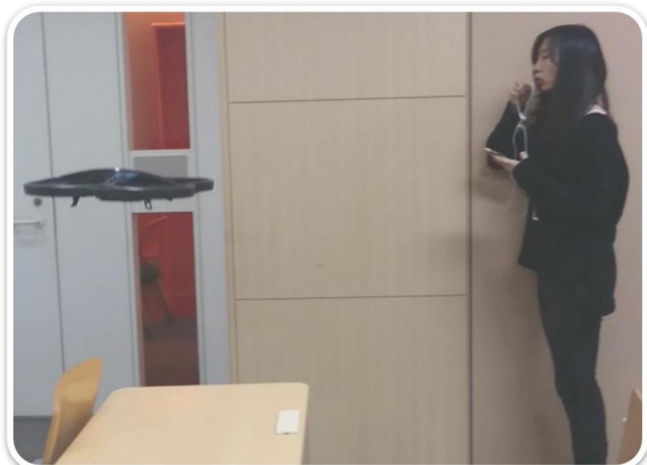
HSMLで作成したアクチュエーションの一例:ユーザーが携帯のマイクに息を吹きかけて、その強弱に応じてドローンの上昇スピードをコントロールできる
